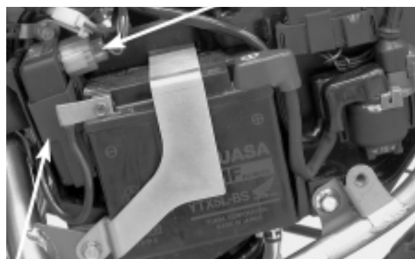
MÓDULO DE CONTROLE DA IGNIÇÃO TAMPA DO ORIFÍCIO DE SINCRONIZAÇÃO
